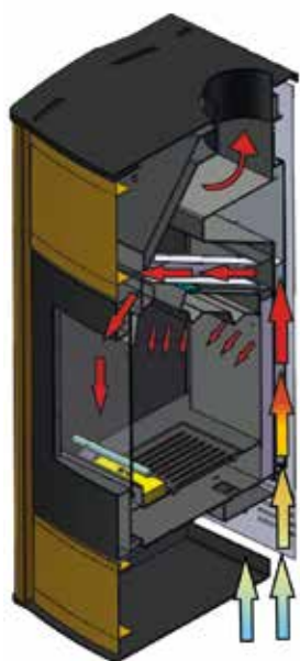
Flujo de circulación de humos. Smoke circulating flow. Modo de circulação dos fumos.
