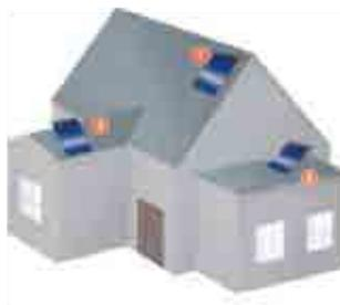
Inclinación del colector 0° a 60°
